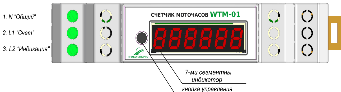
Рис.2 Панель управления и индикации и назначение выводов счётчика моточасов WTM-01
