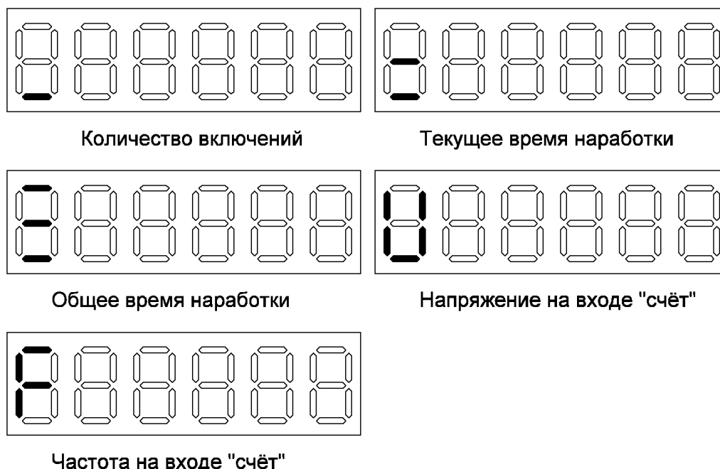
Рис.3 Режимы индикации моточасов WTM-01
