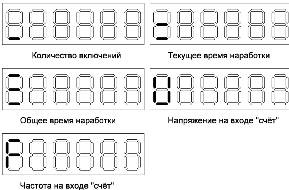
Рис.3 Режимы индикации счётчика моточасов WTM-32
