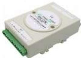
Модули дискретного ввода предназначены сбора данных со встроенных дискретных входов по сети RS-485 по протоколу Modbus или DCON. К дискретным входам подключаются различные виды датчиков. Модуль ввода дискретных сигналов до 220В - 240В.
