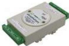
Модули дискретного ввода предназначены сбора данных со встроенных дискретных входов по сети RS-485 по протоколу Modbus или DCON. К дискретным входам подключаются различные виды датчиков. Модуль может крепиться: в шкаф или на стену при помощи винтов или саморезов; на DIN-рейку 35мм; поверх другого модуля, для этого закрепляют отрезок DIN-рейки на нижнем модуле при помощи винтов и второй модуль устанавливают на закрепленную DIN-рейку.
