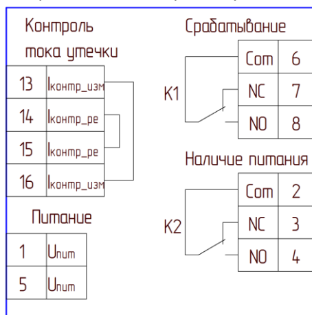
Рисунок 3.2. Схема электрическая подключения реле
