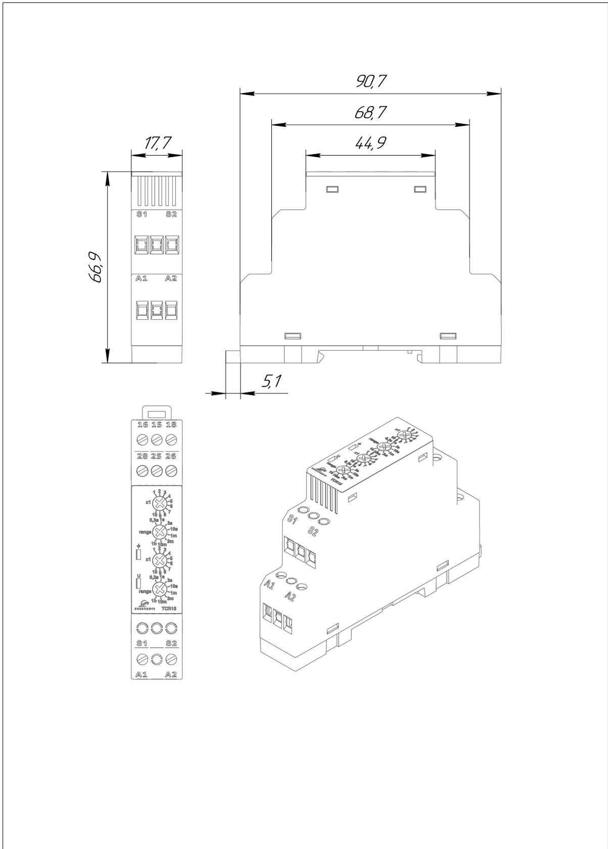
Рис. 3. Габаритные размеры реле времени TCR15
